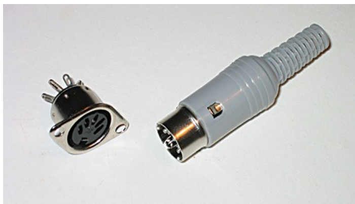
Bild 12. Chassie-hona och Sladd-hane. 5-pol DIN.
