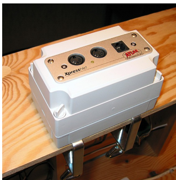
Bild 3. XpressNet anslutning (Atlas-panel)
